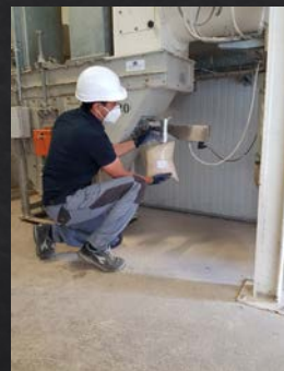
L'operatore preleva dal miscelatore, prima della pellettizzazione i campioni per le analisi
