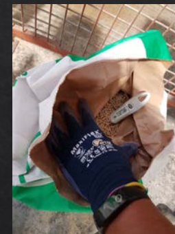
Il controllo della temperatura all'uscita del pellet dopo l'immediato raffreddamento
