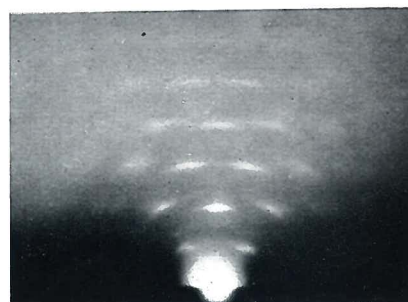
(10 \bar{1} 0) deposito 1 \mu 500A/m 2 pH=1,6 L = 250
