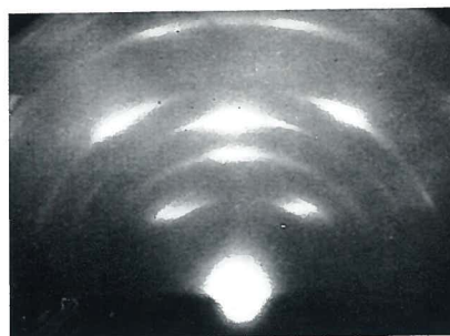
(11 \bar{2} 0) deposito 1 \mu 200A/m 2 pH=1,7 L = 500
