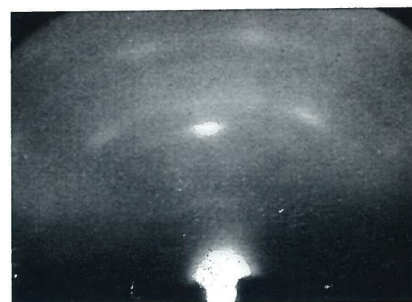
(10 \bar{1} 0) deposito 1 \mu 200A/m 2 pH=4,6 L = 500
