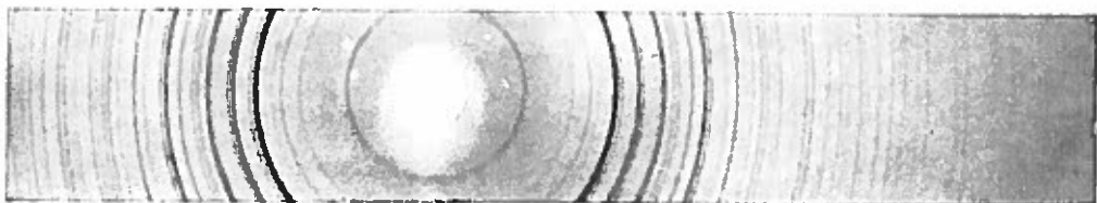
Fig. 5 Spettri ai raggi X ottenuti col metodo di Debye; anticatodo di Cu; filtro di Ni; 8 ore di posa.
