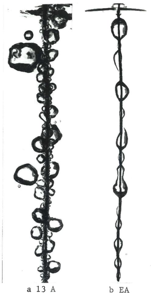
Fig. 22 Sviluppo di cloro su anodo: filiforme-verticale di Pt ( $2r = 0,3$  mm;  $l = 30$  mm), liberamente immerso in soluzione 2 N di HCl. 20 °C.  $\mathcal{I}_c = 14$  A.  $\mathcal{I}_E = 1,5$  A.  $\times 4$ .
