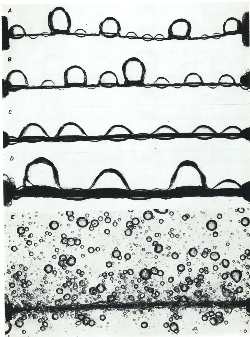
Fig. 17 Aspetti dell'EE su elettrodi di Pt filiformi-orizzontali, di vario diametro (dall'alto in basso:  $2r = 0,2$ ;  $0,3$ ;  $0,5$ ;  $1$ ;  $0,5 \text{ mm}$ ) e lunghezza  $l = 25 \text{ mm}$ , con contorno isolante in azoturo di boro, in soluzione  $2 \text{ N}$  di  $\text{HCl}$ ,  $20^\circ\text{C}$ .
