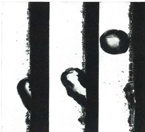
Fig. 12 Crescita e distacco di bolle gassose sotto EE, su elettrodo: piano-verticale. Catodo di grafite (contorno isolante in azoturo di boro). Soluzione 2 N di HCl.  $20^\circ C$ .  $\times 3$ .
