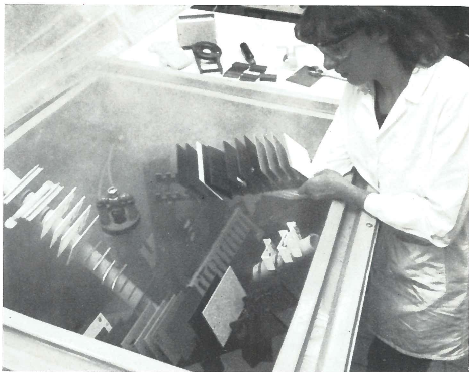
Prove di corrosione in laboratorio.
